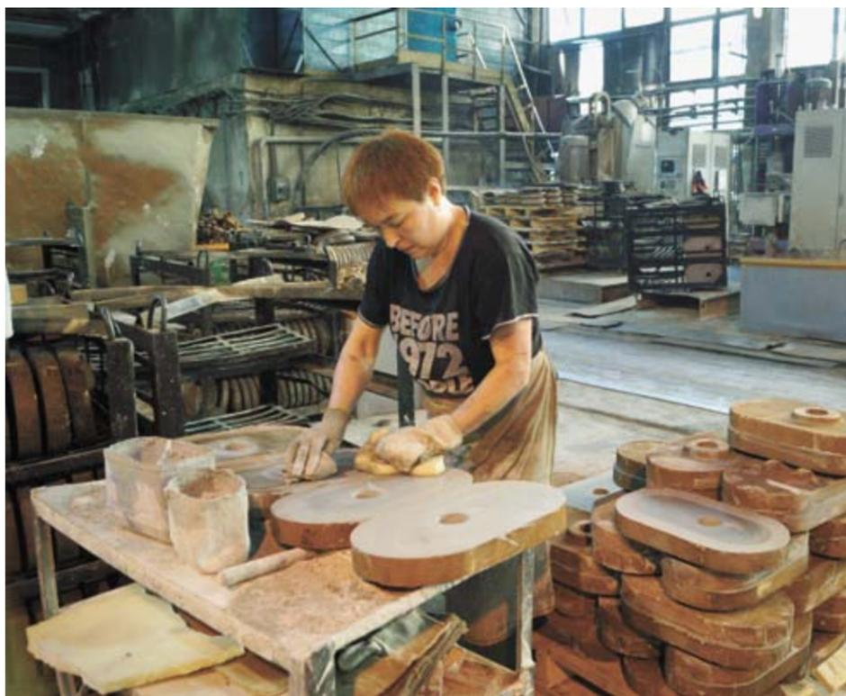
■ Составные периклазовые плиты не назовешь новинкой, выпускаются они на «Магнитовец» с 1979 г. Собираются изделия из двух частей: периклазового вкладыша и основания под него.
